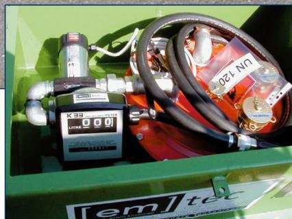
Motorpumpe 12 od. 24 V mit Zählwerk K33
